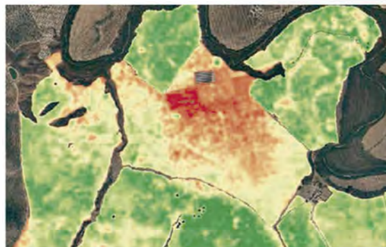
Figura 3 Cartografía del estrés hídrico en una explotación de olivo superintensivo en Jaén. Bellvert, et al. (2012 y 2013) han cartografiado el estado hídrico de un olivar utilizando imágenes térmicas obtenidas desde un Satélite.
